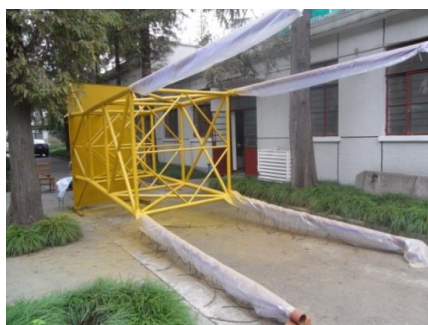
图3 导管架平台试验模型 Fig.3 The test model of jacket platform
